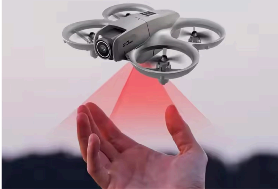
Joonis 6: Droon demonstreerib optilise voolu positsioneerimist stabiilseks hõljumiseks.
